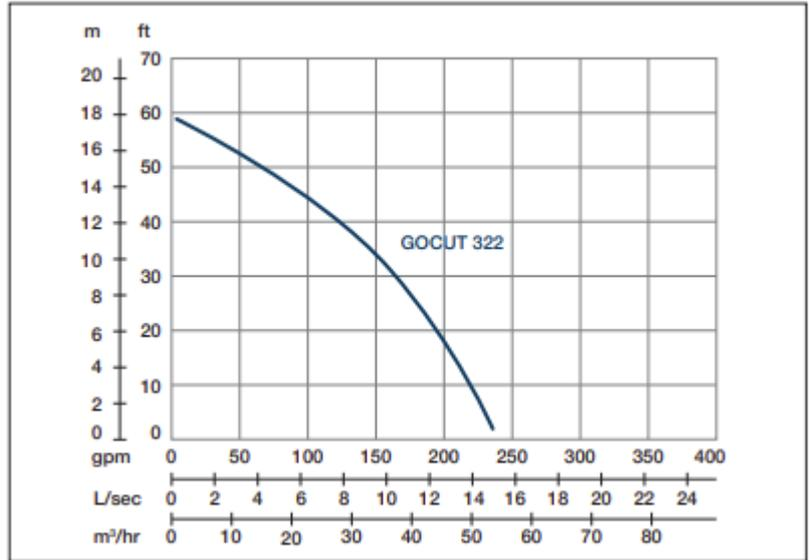
Vitesse nominale : 2850 rpm Passage de solides : 27 mm Refoulement : 80 mm
