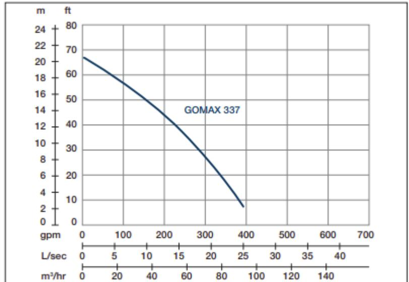
Vitesse nominale : 1450 rpm Passage de solides : 76 mm Refoulement : 80mm
