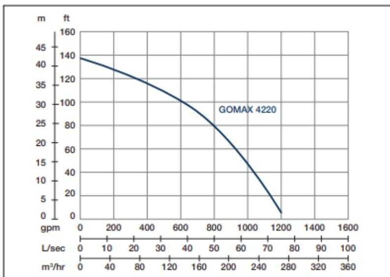
Vitesse nominale : 1450 rpm      Passage de solides : 76 mm      Refoulement : 100 mm
