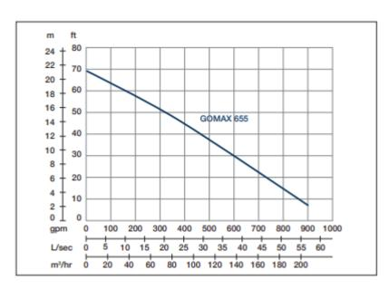
Vitesse nominale : 1450 rpm Passage de solides : 76 mm Refoulement : 150 mm
