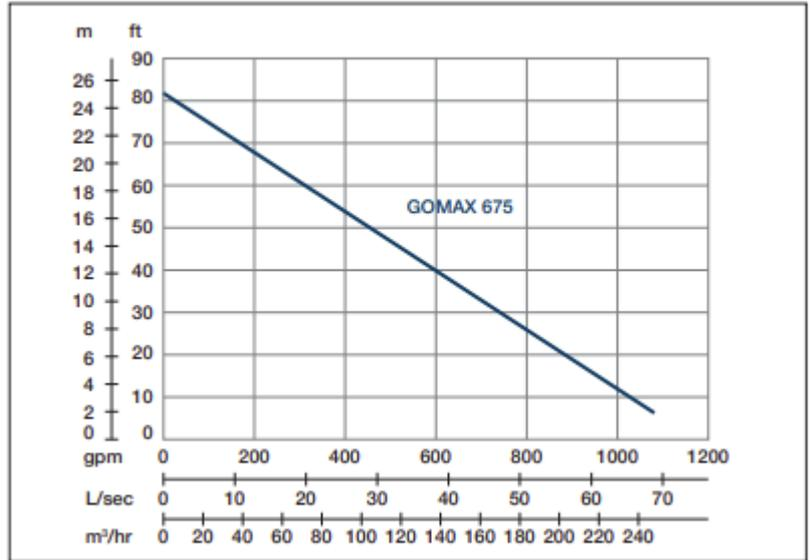
Vitesse nominale : 1450 rpm Passage de solides : 76 mm Refoulement : 150 mm
