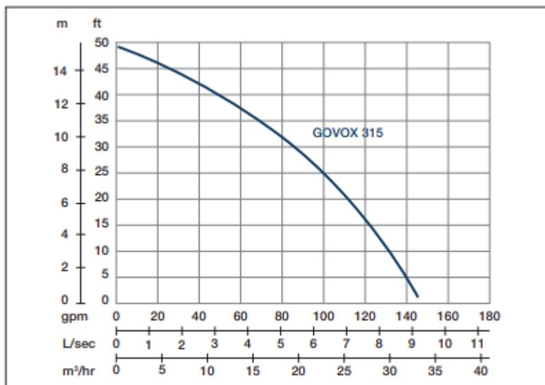
Vitesse nominale : 2850 rpm Passage de solides : 50 mm Refoulement : 80 mm
