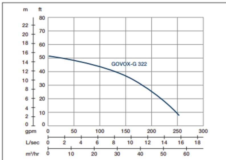
Vitesse nominale : 2850 rpm Passage de solides : 47 mm Refoulement : 80 mm
