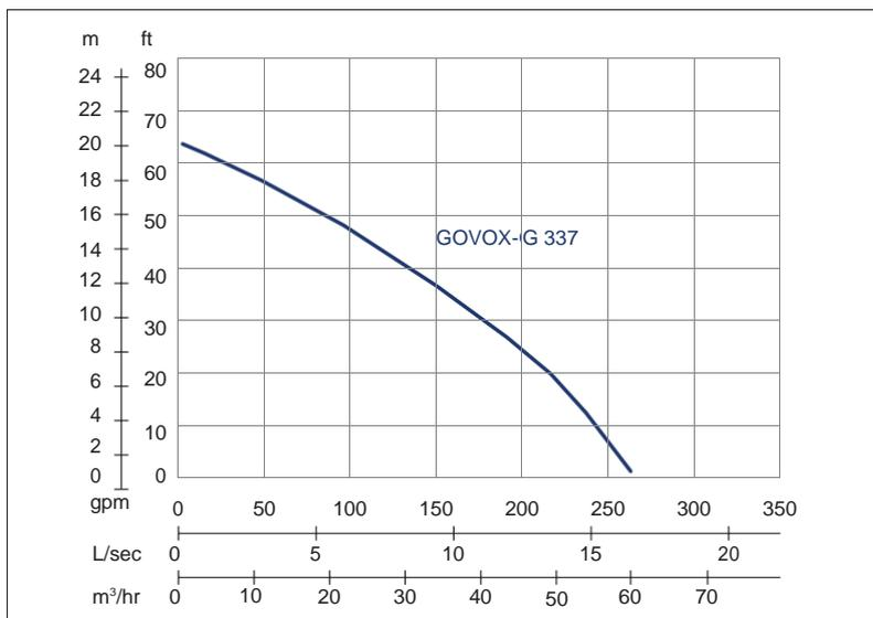
Vitesse nominale : 2850 rpm Passage de solides : 52 mm Refoulement : 80 mm
