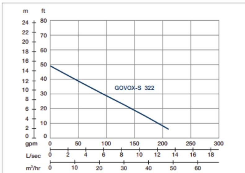
Vitesse nominale : 2850 rpm    Passage de solides : 13 mm    Refoulement : 80 mm
