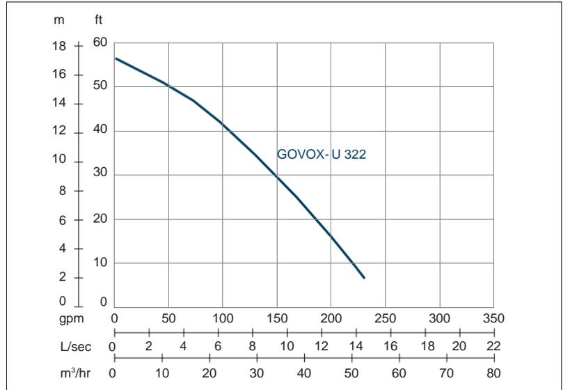
Vitesse nominale : 2850 rpm Passage de solides : 55 mm Refoulement : 80 mm
