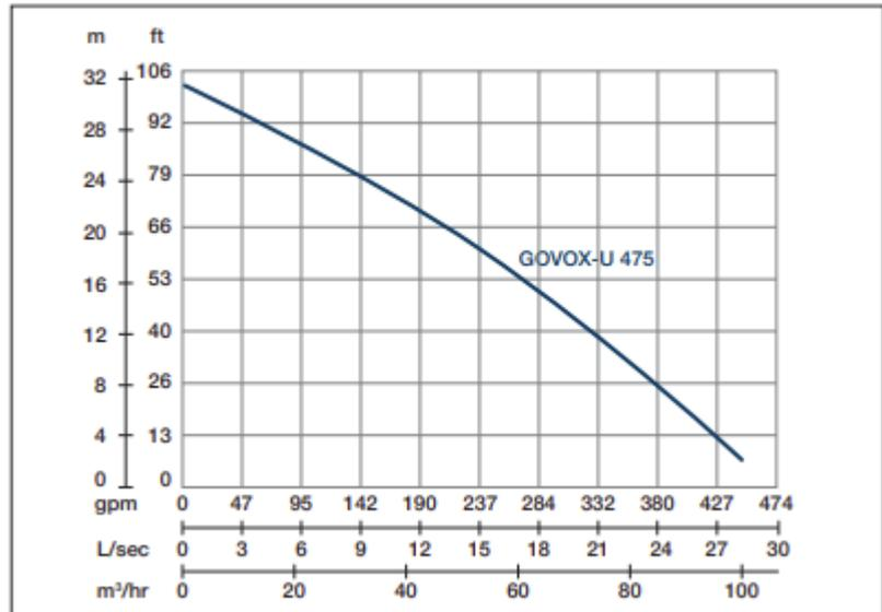
Vitesse nominale : 2850 rpm    Passage de solides : 55 mm    Refoulement : 100 mm
