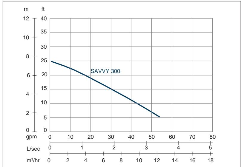
Vitesse nominale : 2850 rpm Passage de solides : 6 mm Refoulement : 50 mm
