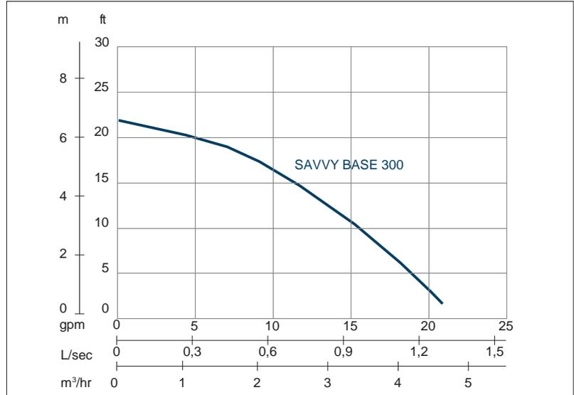
Vitesse nominale : 2850 rpm Passage de solides : 2 mm Refoulement : 25 mm
