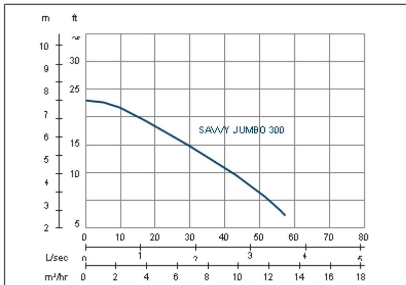
Vitesse nominale : 2850 rpm Passage de solides : 35 mm Refoulement : 50 mm
