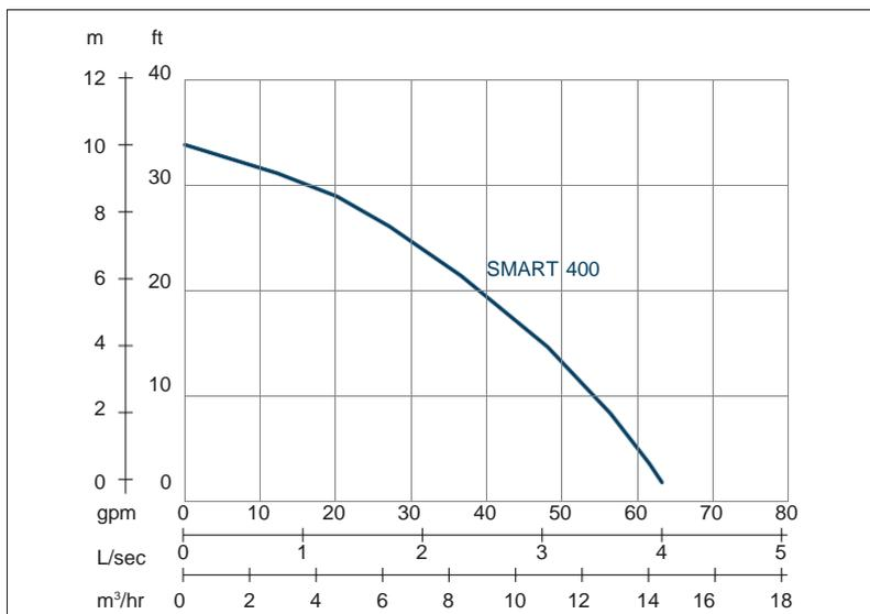
Vitesse nominale : 2850 rpm    Passage de solides : 5,5 mm    Refoulement : 50 mm
