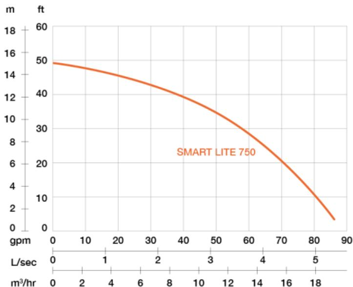
Vitesse nominale : 2850 rpm Passage de solides : 7 mm Refoulement : 50 mm
