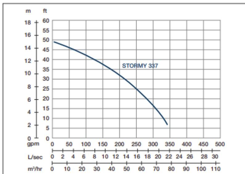
Vitesse de l'arbre : 1450 rpm Passage de solides : 25 mm Refoulement : 80 mm
