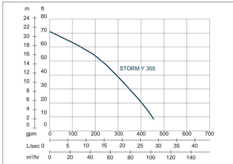
Vitesse nominale : 1450 rpm Passage de solides : 25 mm Refoulement : 80 mm
