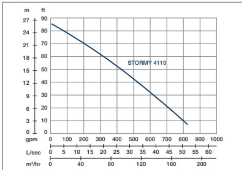
Vitesse nominale : 1450 rpm    Passage de solides : 25 mm    Refoulement : 100 mm
