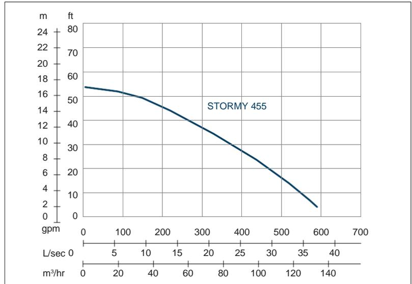
Vitesse de l'arbre : 1450 rpm    Passage de solides : 25 mm    Refoulement : 100 mm
