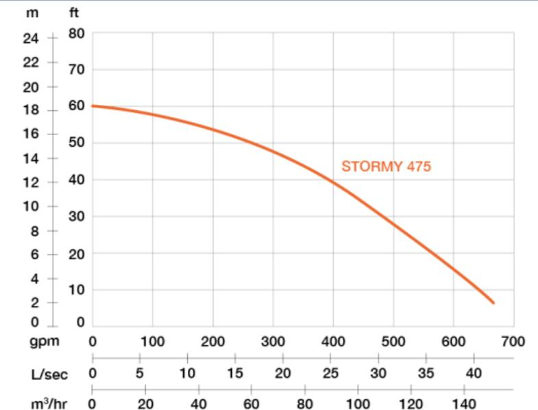
Vitesse nominale : 1450 rpm Passage de solides : 25 mm Refoulement : 100 mm
