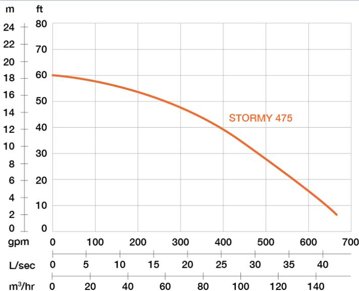
Vitesse de l'arbre : 1450 rpm Passage de solides : 25 mm Refoulement : 100 mm
