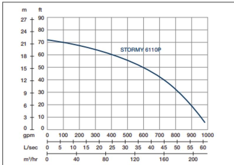
Vitesse nominale : 1450 rpm    Passage de solides : 35 mm    Refoulement : 150 mm
