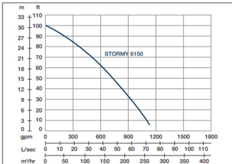
Vitesse de l'arbre : 1450 rpm Passage de solides : 35 mm Refoulement : 150 mm
