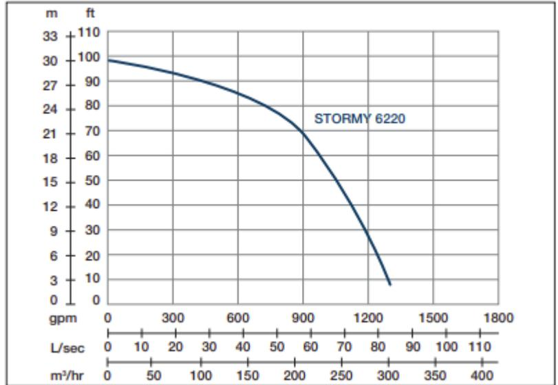
Vitesse de l'arbre : 1450 rpm Passage solide : 30 mm Refoulement : 150 mm
