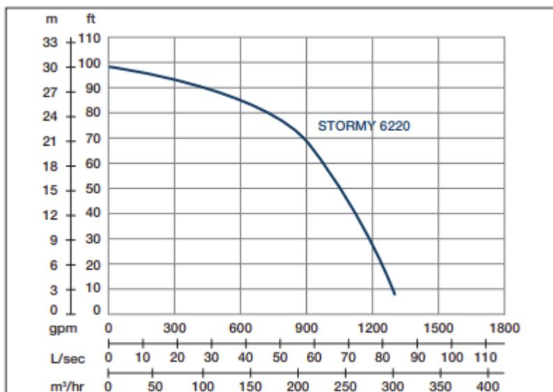
Vitesse de l'arbre : 1450 rpm Passage de solides : 30 mm Refoulement : 150 mm
