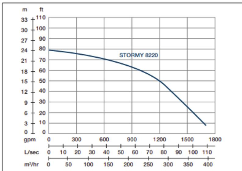
Vitesse de l'arbre : 1450 rpm Passage de solides : 40 mm Refoulement : 200 mm
