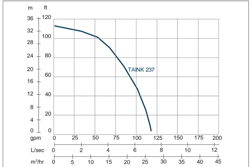
Vitesse nominale : 2850 rpm Passage de solides : 10 mm Refoulement : 50 mm
