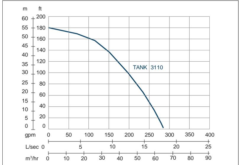
Vitesse nominale : 2850 rpm Passage de solides : 12 mm Refoulement : 80 mm
