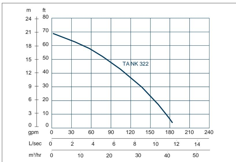
Vitesse nominale : 2850 rpm Passage des solides : 9 mm. Refoulement : 80mm
