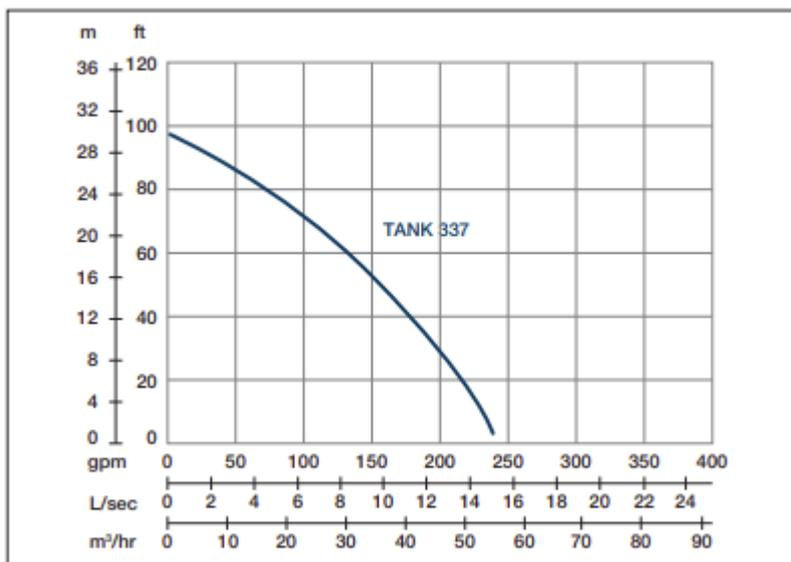
Vitesse nominale : 2850 rpm Passage de solides : 10 mm Refoulement : 80 mm
