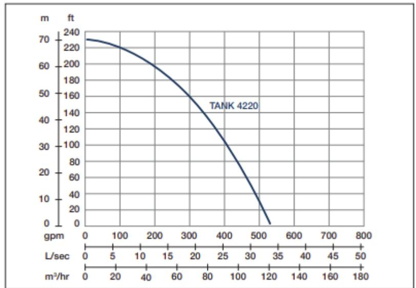
Vitesse nominale : 2850 rpm    Passage de solides : 15 mm    Refoulement : 100 mm
