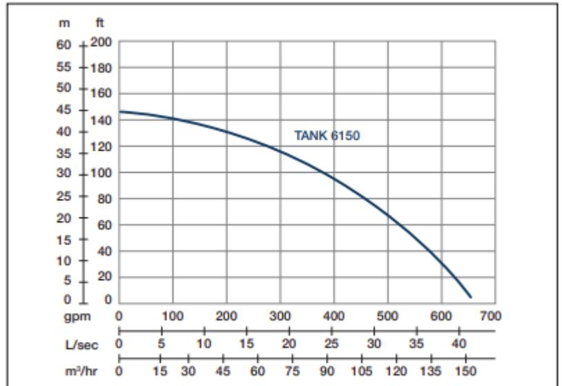
Vitesse nominale : 2850 rpm    Passage de solides : 15 mm    Refoulement : 150 mm
