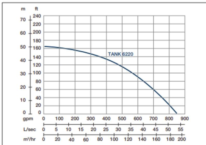
Vitesse nominale : 2850 rpm Passage de solides : 20 mm Refoulement : 150 mm
