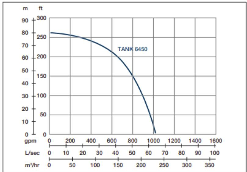
Vitesse nominale : 2850 rpm    Passage de solides : 10 mm    Refoulement : 150 mm
