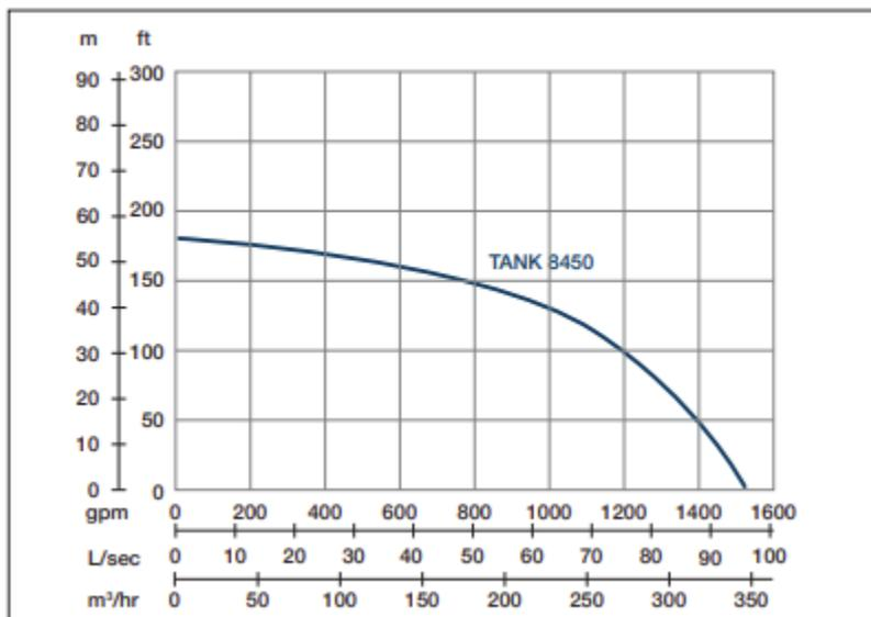
Vitesse nominale : 2850 rpm    Passage de solides : 20 mm    Refoulement : 200 mm
