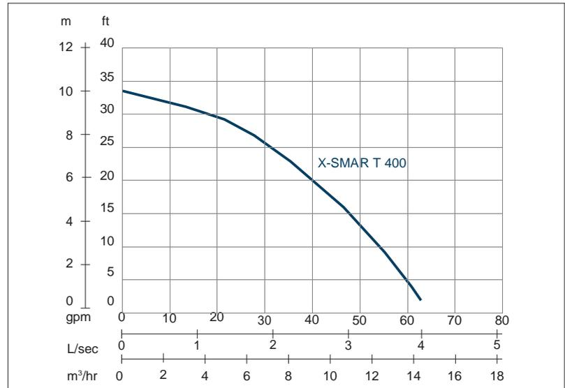
Vitesse nominale : 2850 rpm Passage de solides : 5,5 mm Refoulement : 50 mm
