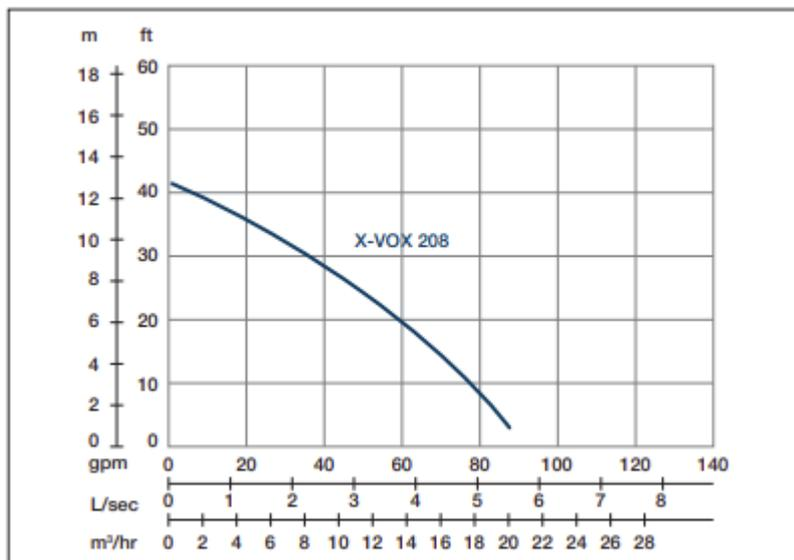
Vitesse nominale : 2850 rpm Passage de solides : 40 mm Refoulement : 50 mm
