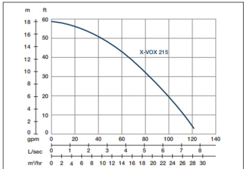
Vitesse nominale : 2850 rpm Passage de solides : 37 mm Refoulement : 50 mm
